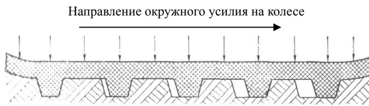
Рис. 10. Схема влияния времени нахождения грунтозацепов в контакте с грунтом на величину передаваемой ими тяги
